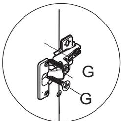
A marcação do **calço central** não vem marcado na lateral, posicionar a porta e fazer a fixação utilizando a mesma como gabarito.
