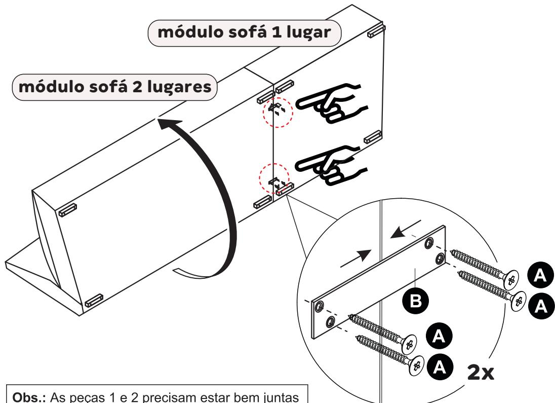
**Obs.:** As peças 1 e 2 precisam estar bem juntas e alinhadas para fixação dos engates (B) no local pré - marcado.
