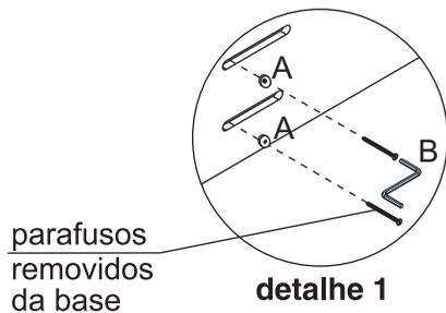
**Este modo de fixação é para uso com as demais bases box do mercado é imprescindível a fixação na parede**
