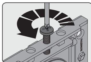
**Obs:** Regular a altura da porta no deslizador inferior com chave philips.
