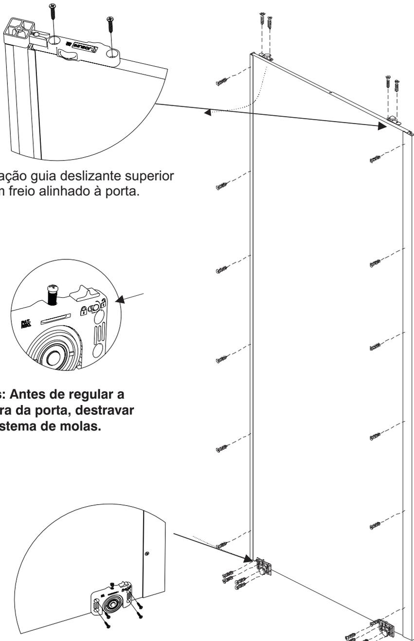
Fixação guia deslizante superior com freio alinhado à porta.
