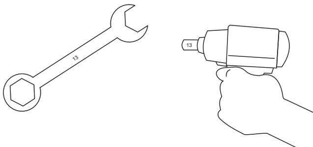
Recomenda-se utilizar uma parafusadeira (não incluída) ou chave de boca nº13 (não incluída) para a remoção dos parafusos.
