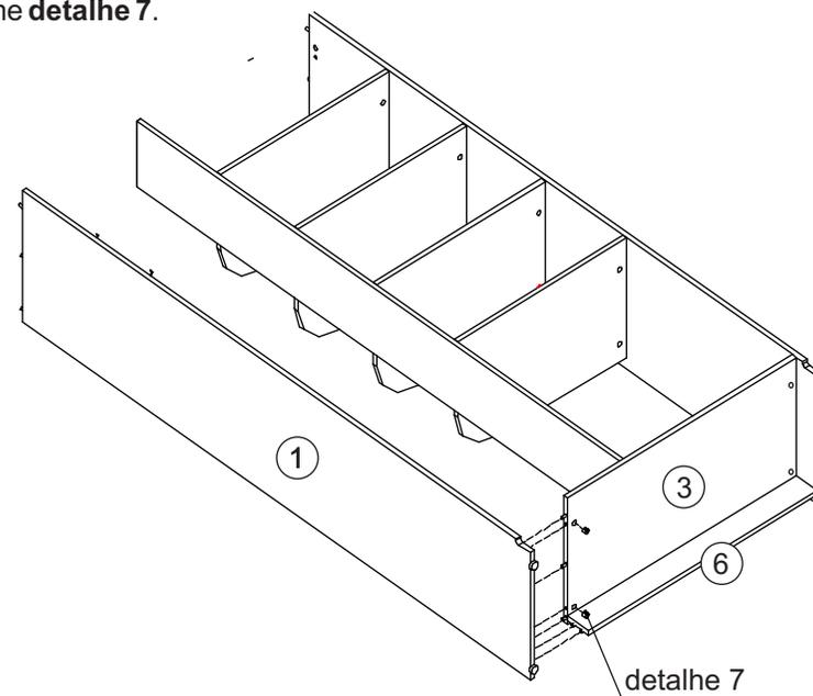
**5** Encaixar o Tampo (9) nas Laterais (1 e 2), fixando-a com os Tambores (I), conforme **detalhe 7**.
