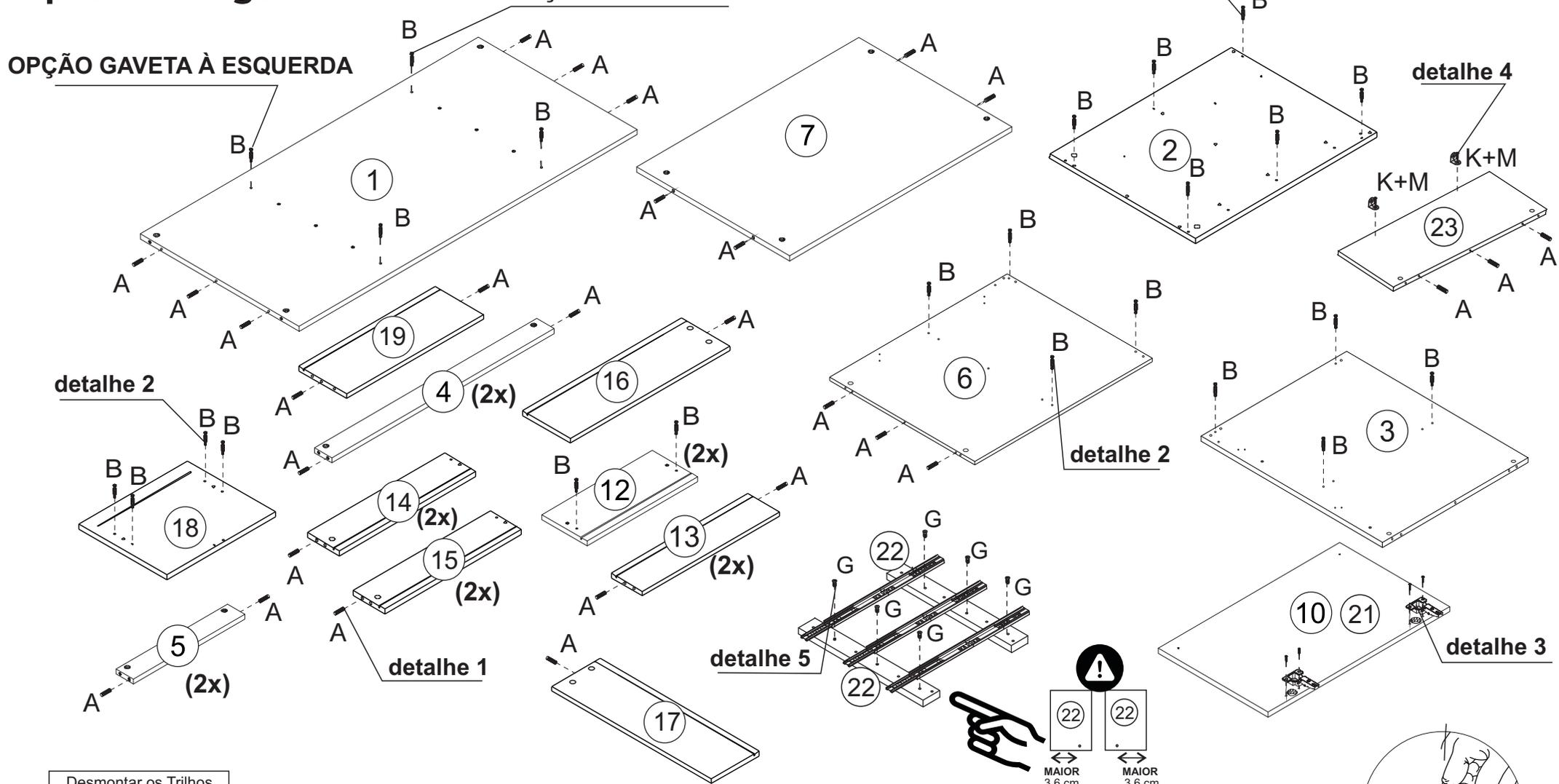
Desmontar os Trilhos Telescópicos abaixando a trava conforme detalhe
