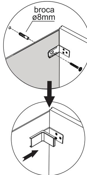
Com uma furadeira+broca de Ø8mm (não fornecidas), fazer o furo do fundo e posicionar o módulo no local desejado; transferir a marcação do furo do suporte para a parede, feitos com a broca de mesmo diâmetro. Efetuar a furação na parede e encaixar as Buchas; fixar o módulo na parede com o parafuso maior do kit. Em seguida, encaixar as capas dos suportes.
