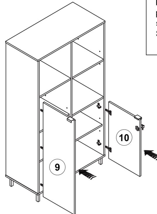
Primeiramente parafusar os puxadores nas portas, para na sequência fixar a fechadura. Somente após, encaixar as portas nas laterais.
