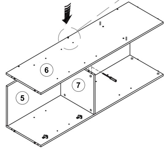
Ao encaixar o pino duplo na divisória, posicionar a ferragem de maneira que ela fique centralizada na furação da peça. Pois ela irá conectar as duas costas. Para facilitar o processo de montagem, parafusar o tambor superior das costas nessa etapa:
