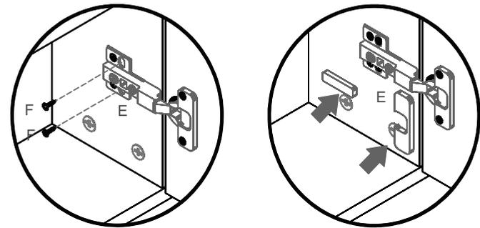
Logo após finalizar os ajustes, fixar em cada dobradiça, os dois últimos parafusos Ø4x16. Na sequência encaixar as duas capas.
