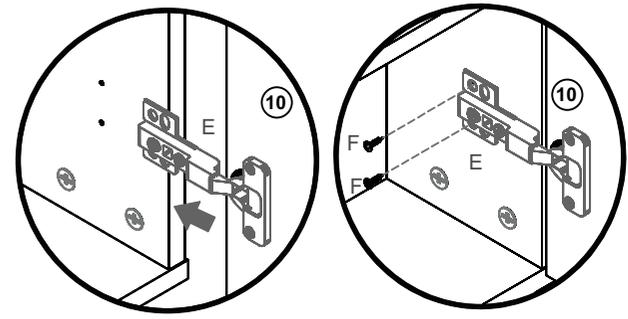
No 2º passo, ao encaixar a porta, fixar mais dois parafusos Ø4x16 em cada dobradiça. Os parafusos serão fixados nas furações mais largas da dobradiça. Usar como guia os furos presentes na lateral esquerda (peça nº 3). Na sequência, ajustar a regulagem conforme os detalhamentos a seguir.
